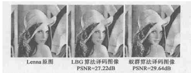
图 2 LBG 算法和 ANT 算法的解码效果图
